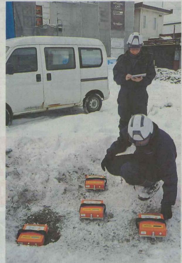
札幌市厚別区の住宅建設予定地で行われた微動探査。4台の地震計を地面に置いて微弱な揺れを計測し、地盤の揺れやすさを判定する。昨年12月
